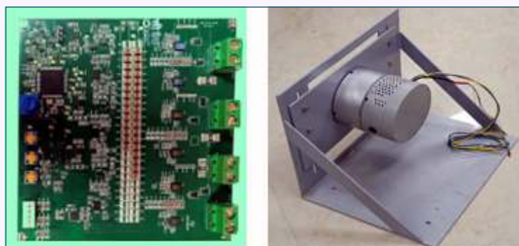
BLDC मोटर के लिए कॉम्पैक्ट 3 kW GaN आधारित एकीकृत ड्राइव सिस्टम
